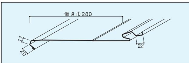
最短成型寸法 (L)=2,000mm
